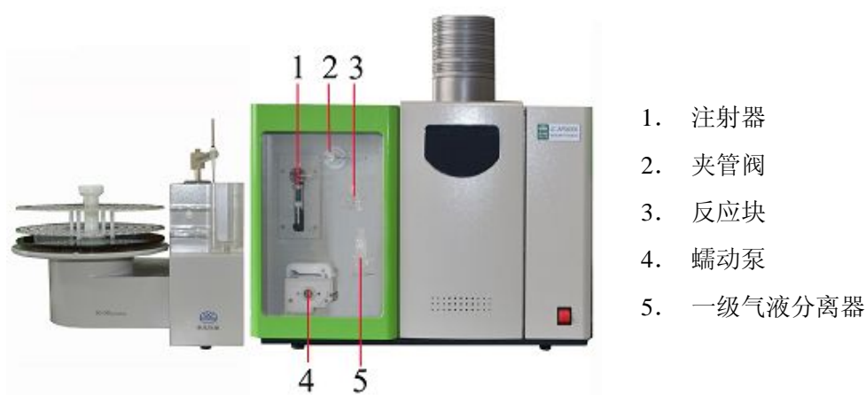
图 3.8 AFS-9750 蒸气发生装置
